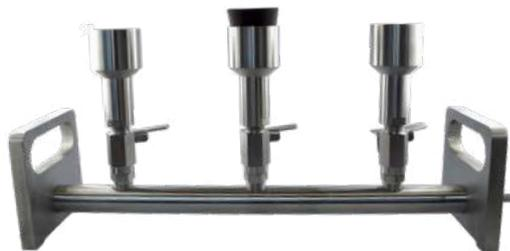
A GVS oferece manifold em aço inox para contagem de bactérias. O manifold está disponível com 3 e 6 posições. O manifold foi especificamente projetado para aplicações microbiológicas. Os suportes porta-filtros são compatíveis com uma tampa n.º 8 perfurada em silicone. Estes dispositivos são compatíveis com os monitores microbiológicos e funis para análises. A superfície é fácil de limpar e permite evitar qualquer contaminação cruzada durante a análise.
