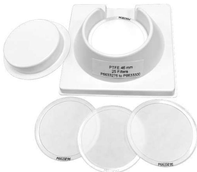
A membrana de PTFE PM 2.5 da GVS é uma membrana fina de elevada pureza para o monitoramento de partículas PM 2.5 no ar ambiente. Cada membrana é seqüencialmente numerada e tem um anel de suporte em polipropileno quimicamente resistente. A reduzida massa da tara permite determinações gravimétricas precisas. Não são usadas colas ou adesivos na produção das membranas e o seu estável design elimina a ondulação, mantendo a membrana plana e permitindo o uso de robôs.
